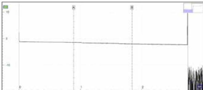
Câbles de test 1 & 2 et lien 3 avec connecteurs APC (événements non définis, c'est-à-dire non visibles)
